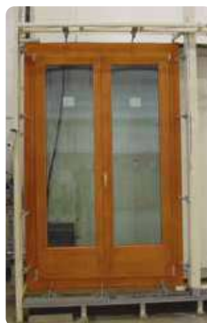
Test de résistance à l'eau et au vent (en lab. externe)
