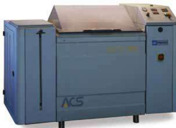
Chambre de brouillard salin: Angelantoni ACS mod. DCTC600
