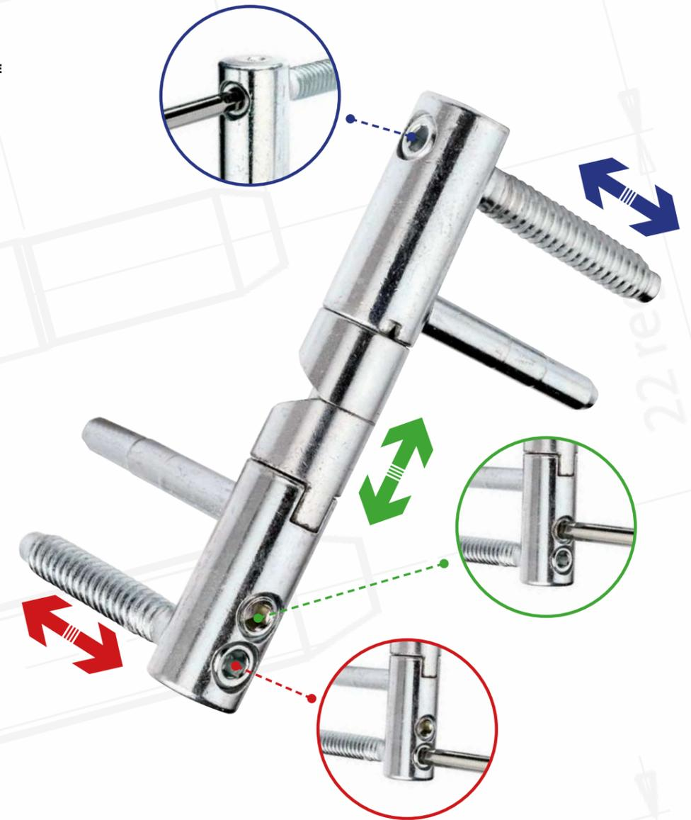
Cerniera di alta qualità, regolabile su tre assi ed alzante: **mentre si apre la porta l'anta si alza di 5 mm**. È particolarmente adatta a porte ampie e pesanti installate in concomitanza di pavimenti antichi, con dislivelli o con spessori dovuti a moquette e tappeti. Disponibile nel diametro da 16 millimetri.
