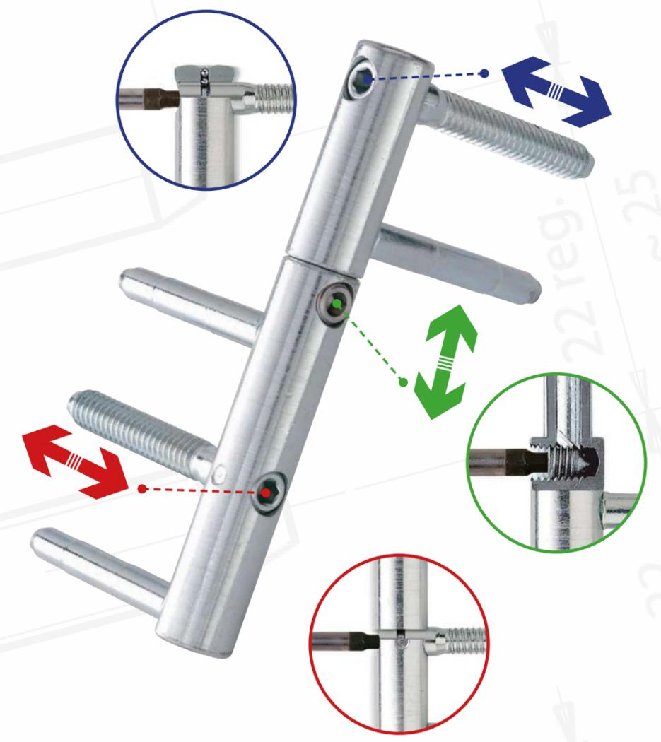
URSUS Con i suoi 5 gambi, garantisce stabilità, portata ed un perfetto allineamento dell'anta; è **adatta a porte e portoni particolarmente pesanti e con ante particolarmente grandi**, permette la regolazione verticale, laterale ed in profondità. Il maschio a 3 gambi è intercambiabile con diverse versioni di Exacta. Disponibile nei diametri da 16 e 18 millimetri.
