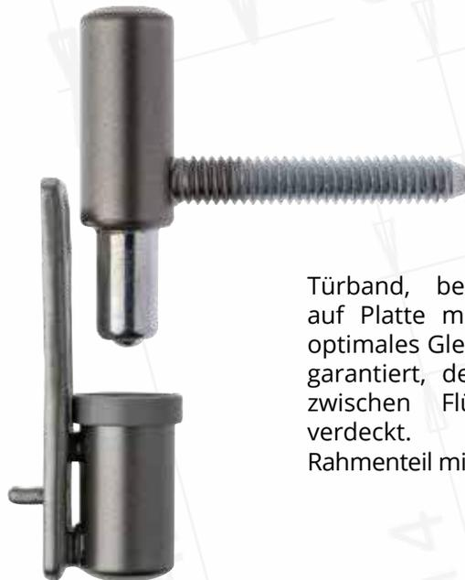
Türband, bestehend aus Flügelteil auf Platte mit Nylonbuchse, die ein optimales Gleiten von Stift und Kragen garantiert, der einen etwaigen Spalt zwischen Flügel- und Rahmenteil verdeckt.
