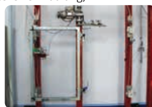
Verschleißfestigkeitstest für Türangeln
