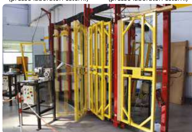
Prova di resistenza all'usura I.U.S. Otlav
