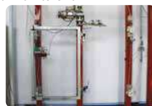
Prova di resistenza all'usura per cardini
