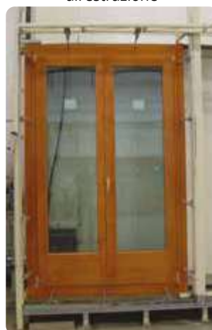
Prova di resistenza acqua e vento (presso laboratori esterni)
