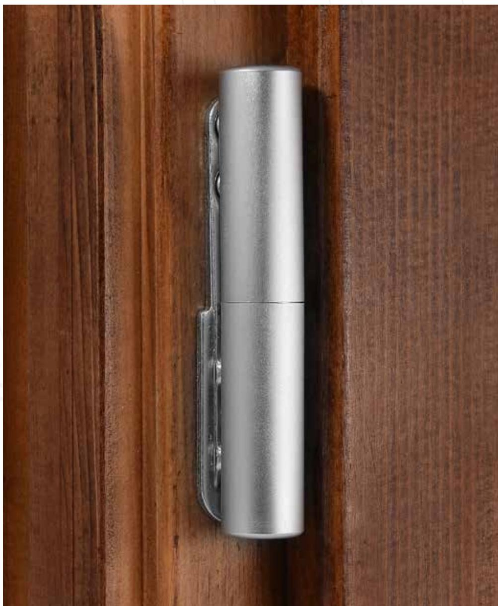
La fiche Bixacta est née de l'exigence d'avoir à disposition une fiche réglable pour porte d'entrée PVC, bois et aluminium et qui offre également des caractéristiques esthétiques épurées. Réglable en 3 directions, la partie fixée sur l'ouvrant doit être introduite dans la gorge européenne 12 et axe 13 ou 9 mm, la partie male peut être remplacée par la male Exacta ou Ursus 16 mm. Disponible en diamètre 16 mm.
