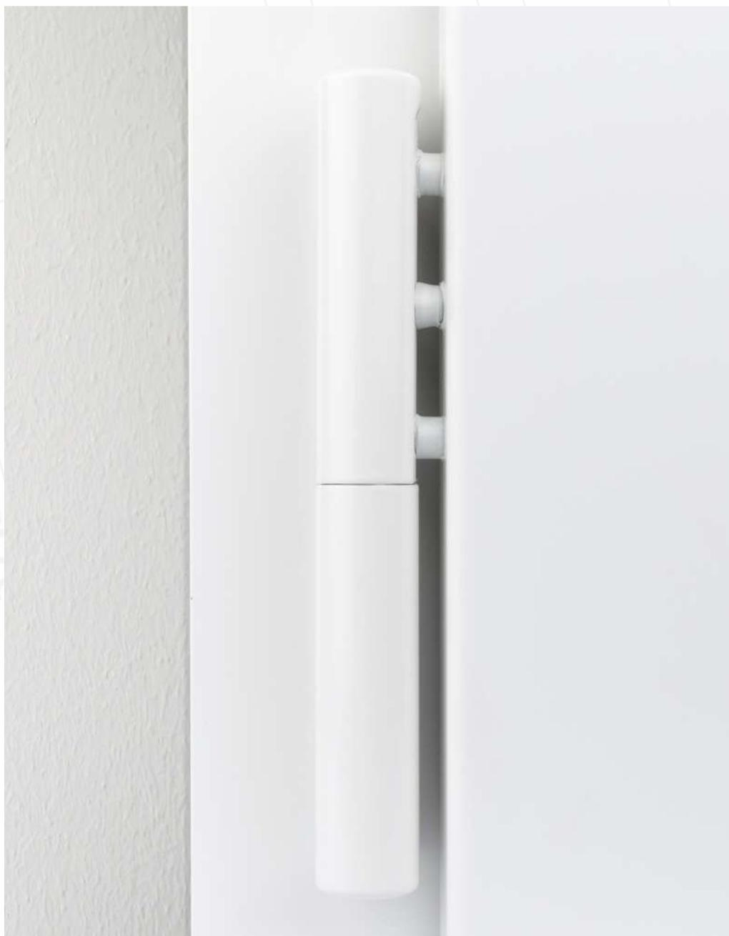
**URSUS-PVC** se compose d'une femelle à 3 tiges et d'un mâle sur platine avec 4 trous de fixation. Elle garantit stabilité, charge élevée et le maintien d'un parfait alignement de l'ouvrant. Elle est adaptée aux portes particulièrement lourdes et avec un ouvrant très grand. Elle est réglable sur **3 axes** avec une seule clé hexagonale 4 mm. Elle peut également être installée sur des profilés en bois.
