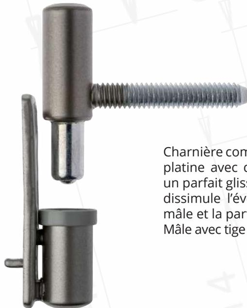
Charnière composée d'une fiche femelle sur platine avec douille en nylon garantissant un parfait glissement du pivot. La collerette dissimule l'éventuel écart entre la partie mâle et la partie femelle. Mâle avec tige M7x43 mm.
