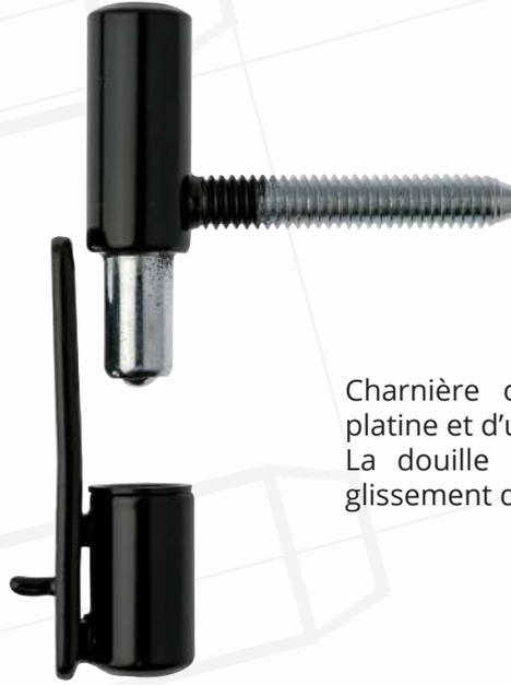
Charnière composée d'une femelle sur platine et d'un mâle avec tige M7x40 mm. La douille en nylon garantit un parfait glissement du pivot.
