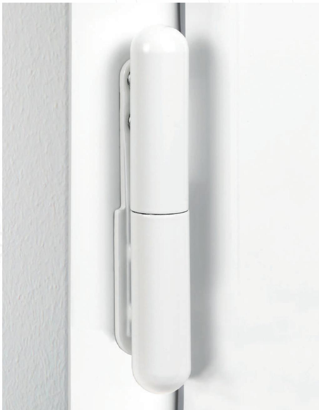
Fiche certifiée CE, la partie femelle peut être introduite dans la **gorge européenne 12, axe 13 mm ou axe 9 mm**. Le mâle se décline en trois versions différentes de picots et deux modèles de platine. Au design discret et élégant, cette charnière se distingue par la facilité d'installation et le **réglable tridimensionnel** possible avec la porte déjà posée. Disponible en différentes finitions, elle peut également être installée sur des profilés en bois avec gorge européenne.
