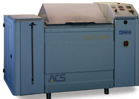
Cámara de niebla salina: Angelantoni ACS mod. DCTC600.
