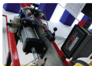
Prueba de resistencia a la extracción
