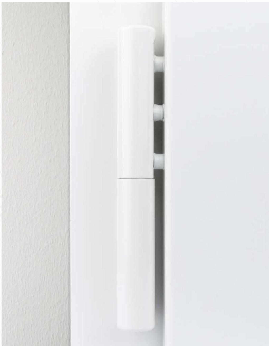
**URSUS-PVC** está compuesta por una hembra de 3 tornillos y un macho con placa de 4 orificios de fijación y, por consiguiente, garantiza estabilidad, capacidad y una perfecta alineación de la hoja; es idónea para puertas y portones especialmente pesados y con hojas especialmente grandes.
