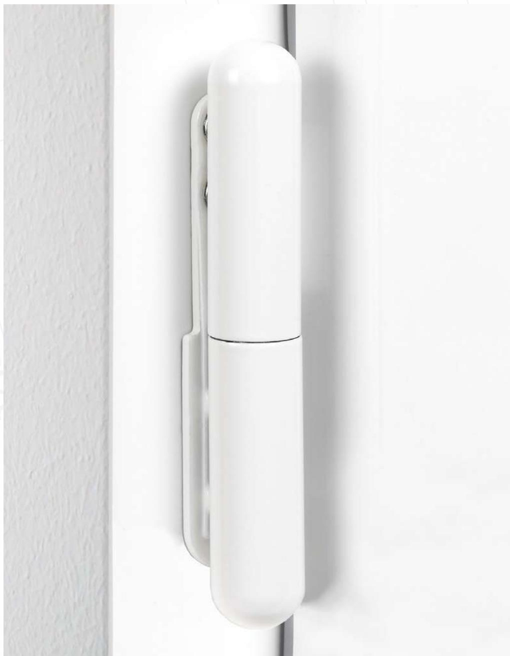
Bisagra **certificada CE**, la parte hembra es idónea para insertarse en **cámara europea con aire de 12 mm, eje 13 mm o eje 9 mm**. El macho está disponible con **3 tipos diferentes de enganches**. Con un diseño discreto y elegante, destaca por su facilidad de instalación y regulación tridimensional con la hoja montada. Disponible en varios acabados, puede instalarse también en perfiles de madera con cámara europea.
