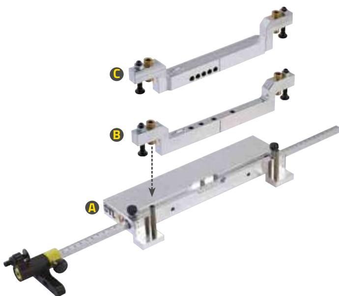
La plantilla Rollacta, gracias a sus características únicas, permite una instalación fácil, precisa y rápida de las bisagras. Consta de una pieza base **(A)** apta para su instalación en todo tipo de perfiles de PVC. Los kits **(B y C)** se personalizan según el sistema de perfil utilizado. La plantilla se puede utilizar indistintamente en puertas derechas y izquierdas. Barra milimétrica disponible a petición.
