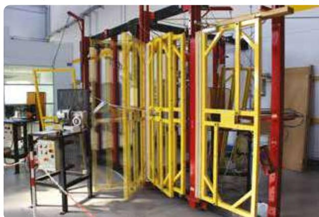
Prueba de resistencia al desgaste IUS OTLAV
