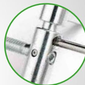
Maniobrando el perno roscado, es posible montar rápidamente la parte hembra en la puerta, con el inserto hexagonal previsto para enroscadores eléctricos, para efectuar seguidamente el ajuste lateral de precisión usando la llave "T" prevista. El paso amplio y autoenroscador garantiza una mayor velocidad de montaje, un ajuste perfecto de la puerta o de la ventana y un excelente aguantar en todos los tipos de madera.
