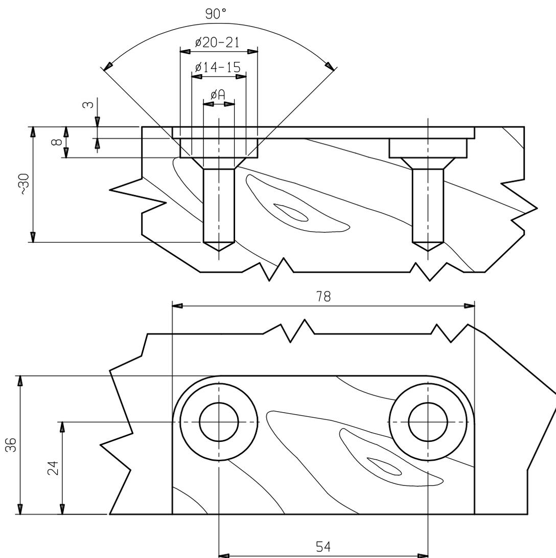
Il  $\emptyset$  del foro "A" per la sede della boccia filettata di regolazione e' in relazione al tipo di legno impiegato. Per legni teneri  $\emptyset$  consigliato 10-10.2. Si consiglia comunque di eseguire delle prove preliminari per individuare il  $\emptyset$  piu' corretto.
