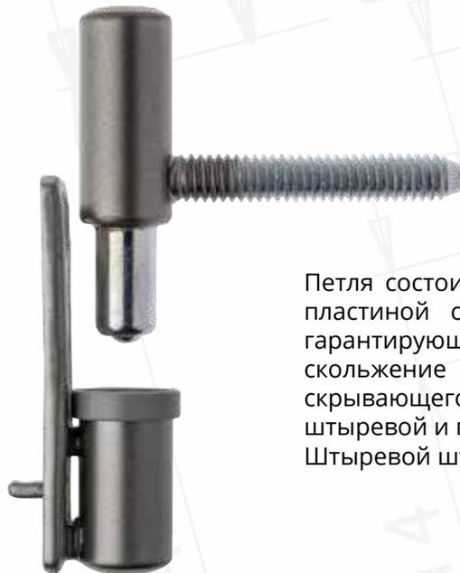
Петля состоит из гнездовой части с пластиной с нейлоновой втулкой, гарантирующей оптимальное скольжение штифта, и воротника, скрывающего любой зазор между штыревой и гнездовой частями. Штыревой штифт M7x40 мм.
