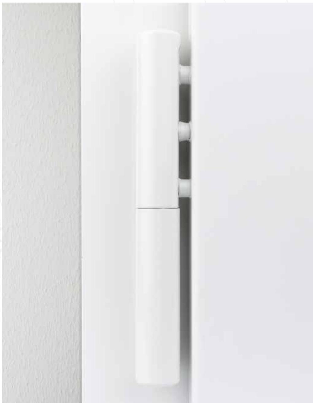
URSUS-PVC состоит из гнездовой части с 3 штифтами и штыревого штифта с пластиной, оснащенной 4 крепежными отверстиями, поэтому гарантирует устойчивость, несущую способность и идеальное выравнивание створки; подходит для особенно тяжелых дверей и ворот с особенно большими створками.
