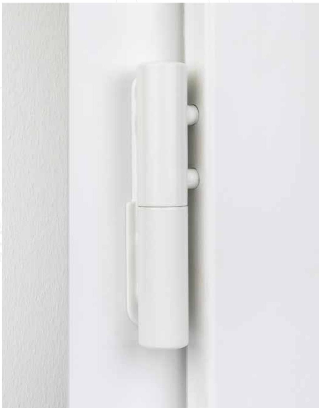
Петля сдержанного и элегантного дизайна отличается простотой установки и регулировки по двум осям при установленной створке. Штыревая часть доступна с тремя различными типами штифтов и двумя моделями пластин. Mixasta 482 доступна в версии Ø16, а по запросу также в версии Ø14.
