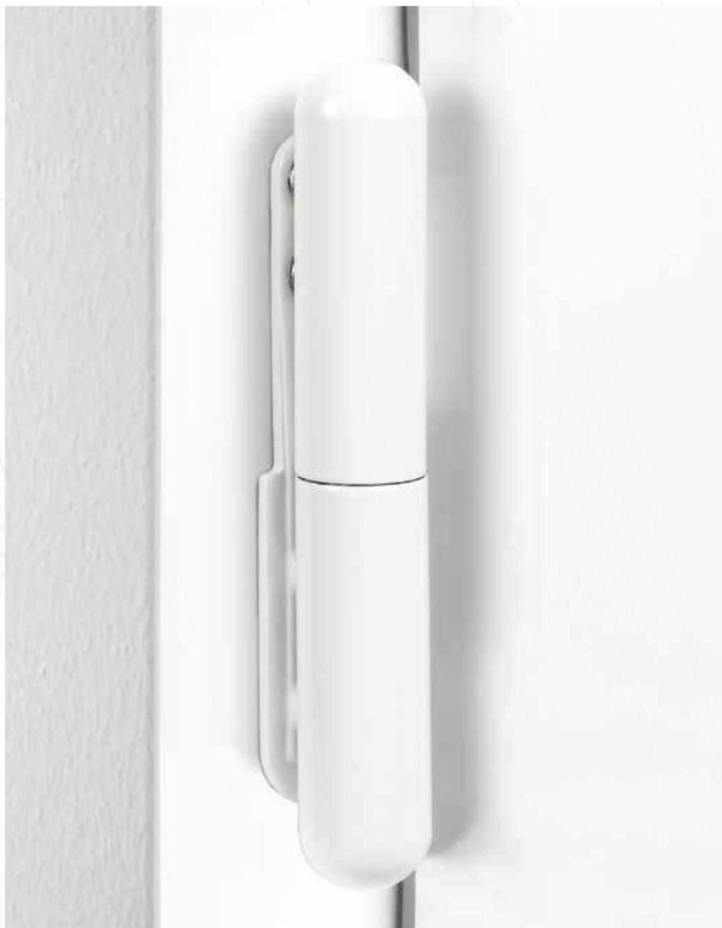
Петля сертифицирована CE, гнездовая часть подходит для вставки в европаз с воздухом осью 12 мм, осью 13 мм или осью 9 мм. Штыревой штифт доступен с тремя различными типами штифтов и двумя моделями пластин. Обладая сдержанным и элегантным дизайном, она отличается простотой установки и трехмерной регулировкой при установленной створке. Доступна в различных вариантах отделки, а также может быть установлена на деревянные профили, оснащенные европазом.
