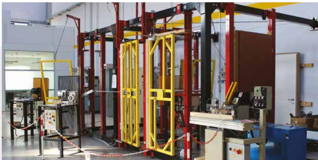
Вид на испытательные лаборатории OTLAV I.U.S. (Симулятор интенсивного использования)
