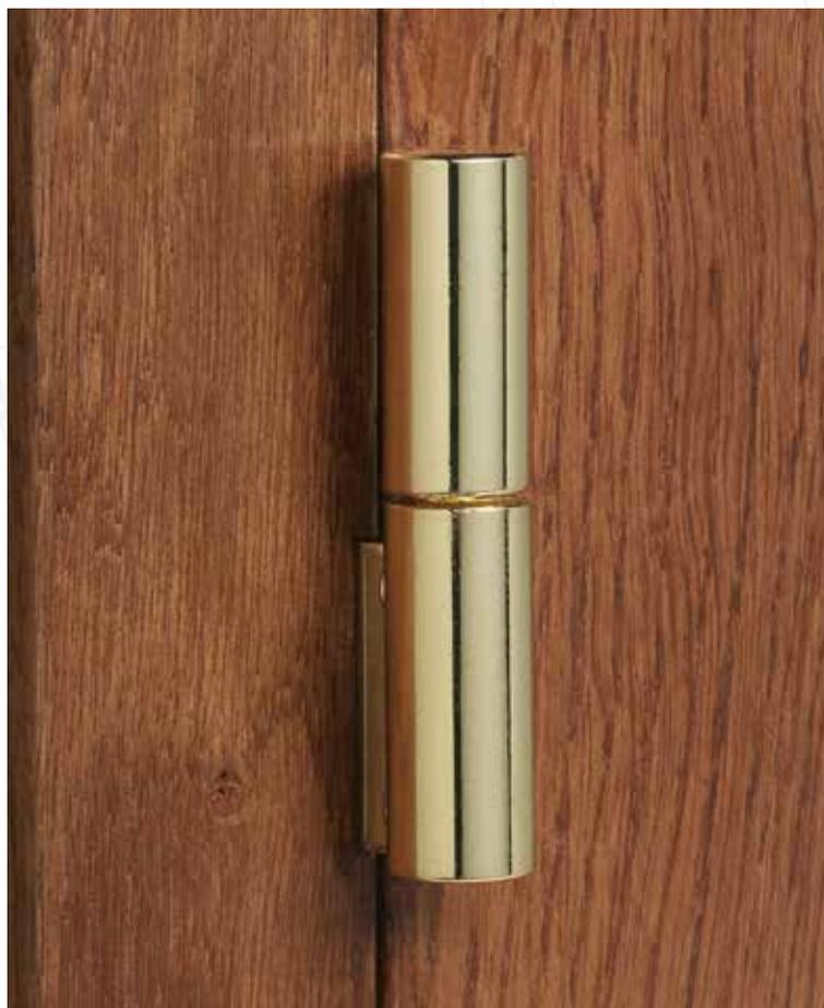
Петля предназначена для окон и дверей заподлицо и гарантирует несущую способность и надежность. Регулируется по высоте при установленной створке. Доступна в диаметре 14 мм.
