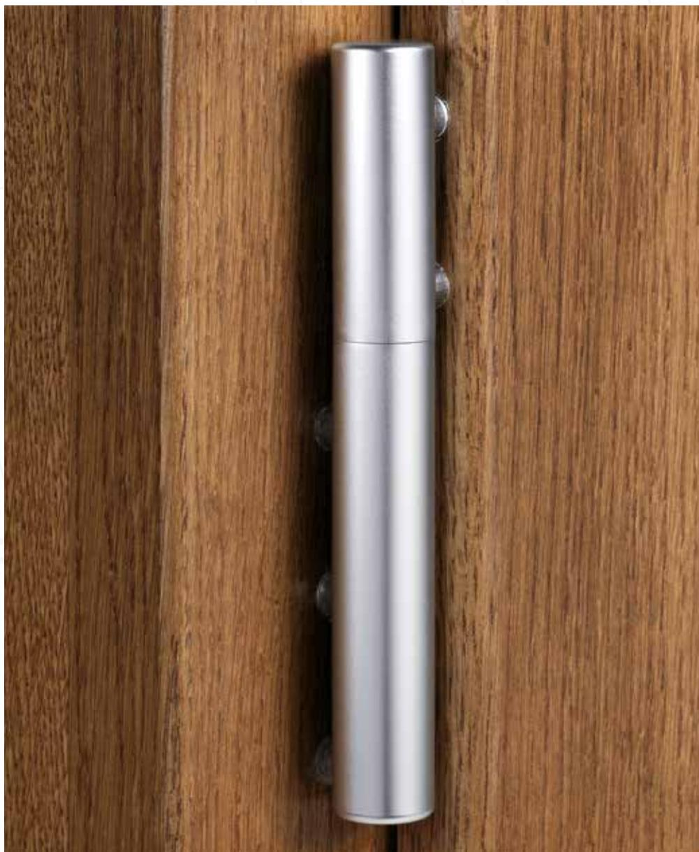
Петля URSUS благодаря своим 5 штифтам гарантирует устойчивость, несущую способность и идеальное выравнивание двери; подходит для тяжелых дверей и ворот с особенно большими створками, обеспечивает вертикальную, боковую регулировку и глубину. Трехстоечный штифт взаимозаменяем с различными версиями Ехаста. Доступен диаметр 16 и 18 мм.
