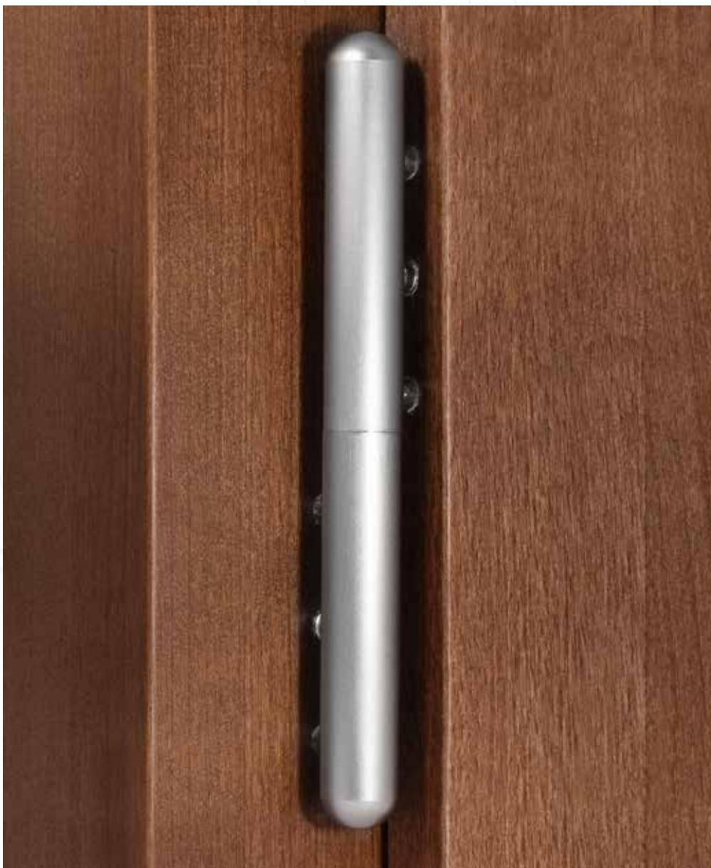
Оснащен 6 штифтами, что гарантирует исключительную устойчивость двери. Подходит для тяжелых дверей и ворот с особенно большими створками, гарантирует идеальное выравнивание ворот. Обеспечивает вертикальную, боковую и глубинную регулировки. Доступен диаметром 14, 16 и 18 мм.
