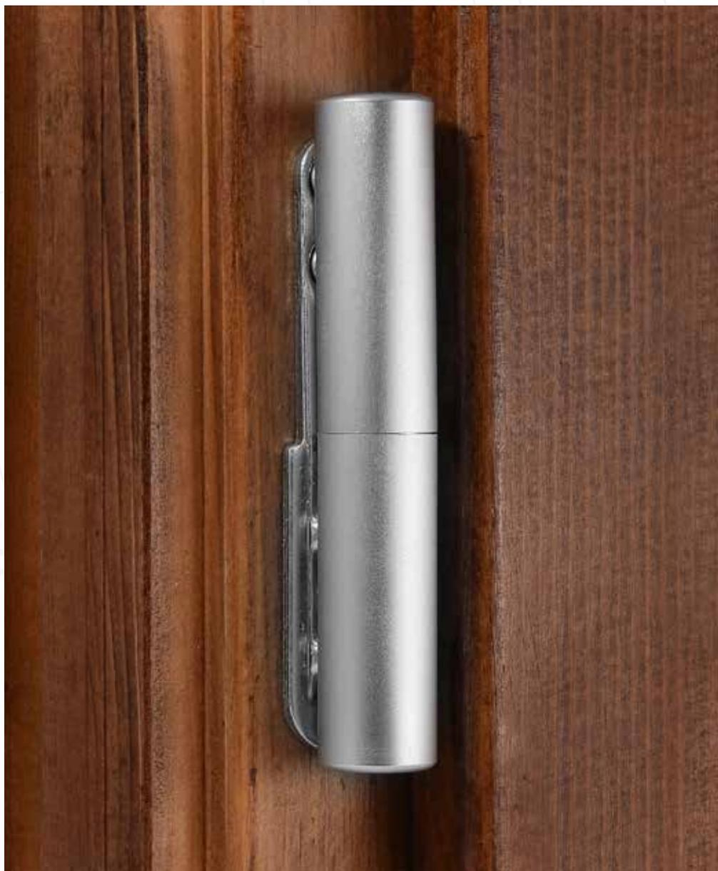
Віхаста родилась из необходимости иметь регулируемую петлю для ПВХ, деревянных и алюминиевых дверей, учитывающую эстетическое воздействие на двери. Регулируется в 3-х направлениях; часть, прикрепленная к створке, вставляется в паз 12 с осью 13 или 9 мм, штыревая часть взаимозаменяема с штыревой частью Ursus или Exacta Ø 16 мм. Доступна в диаметре 16 мм.
