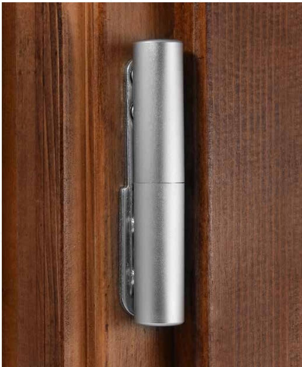
Bixacta nasce dall'esigenza di disporre di una cerniera regolabile per **portoncini in PVC, legno ed alluminio**, che tenga conto dell'impatto estetico sul serramento. Regolabile in 3 direzioni, la parte applicata sull'anta viene inserita nella cava in aria 12 con asse 13 oppure 9 mm, la parte maschio è intercambiabile con il maschio Ursus o Exacta Ø 16mm. Disponibile nel diametro da 16 millimetri.
