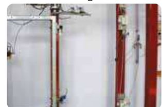
Verschleißfestigkeitstest für Türangeln (bestimmte Komponente)
