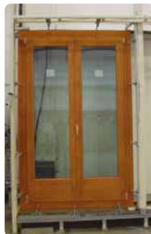
Wasser- und Wind Beständigkeitstest (bei externen Labors)
