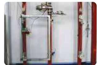
Verschleißfestigkeitstest für Türangeln
