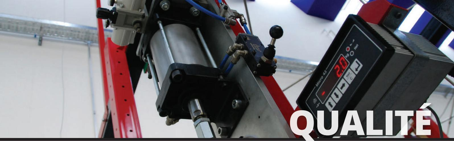
Conformément aux normes européennes et au règlement UE 305/2011, toutes les fiches OTLAV sont soumises à des tests de résistance sévères qui vérifient leurs prestations, aussi bien en phase de projet que périodiquement, une fois l'industrialisation terminée. L'appareil utilisé pour les essais dans le Laboratoire Test OTLAV est un Simulateur d'Utilisation Intensive (I.U.S).
