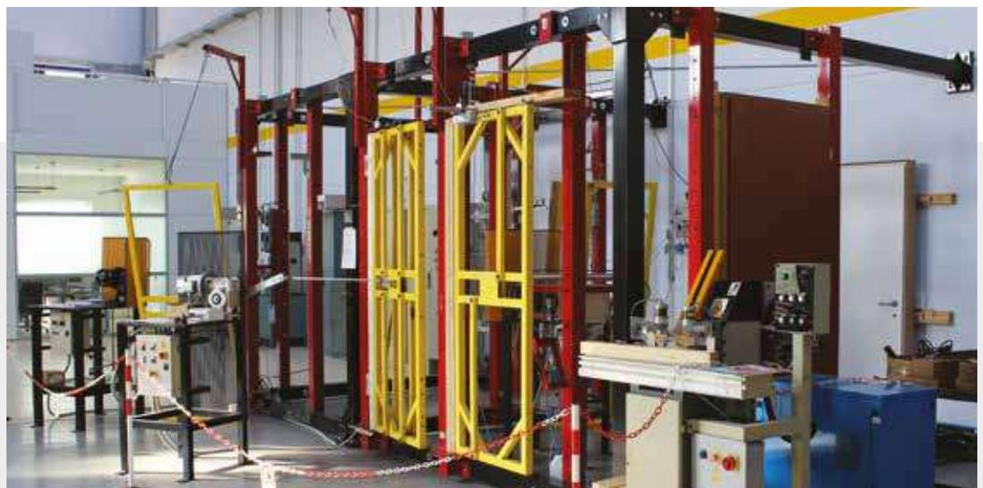
Vista dei Laboratori Test OTLAV I.U.S. (Simulatore di Utilizzo Intensivo)
