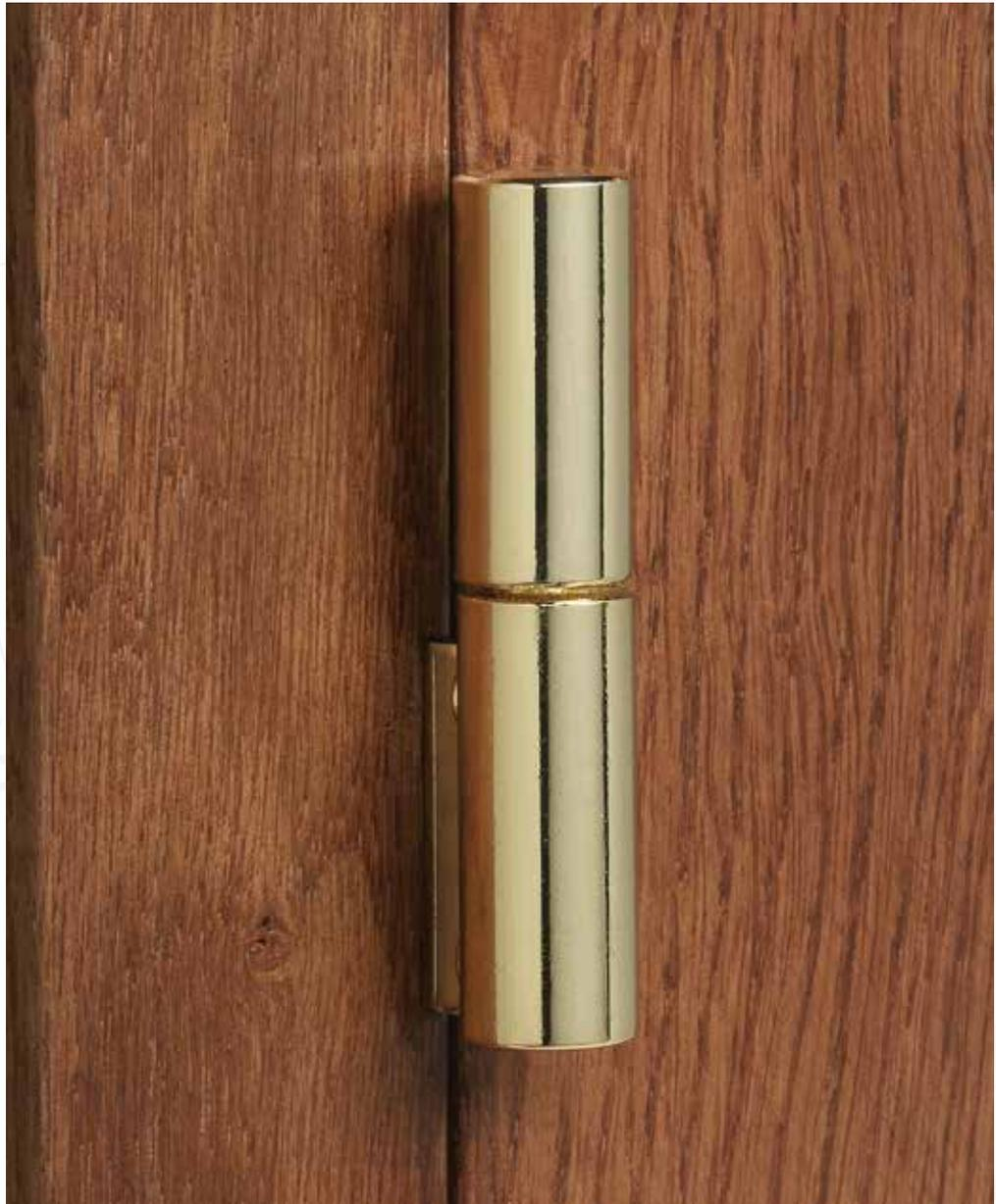
Cerniera progettata per i serramenti a filo, garantisce portata ed affidabilità. È regolabile in altezza con anta montata. Disponibile nel diametro da 14 millimetri.
