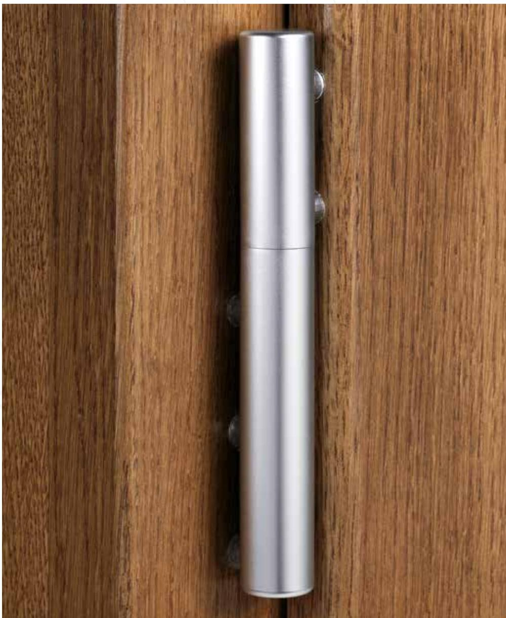
La cerniera URSUS, grazie ai suoi 5 gambi, garantisce stabilità, portata ed un perfetto allineamento dell'anta; è **adatta a porte e portoni pesanti e con ante particolarmente grandi**, permette la regolazione verticale, laterale e in profondità. Il maschio a 3 gambi è intercambiabile con diverse versioni di Exacta. Disponibile nei diametri da 16 e 18 millimetri.
