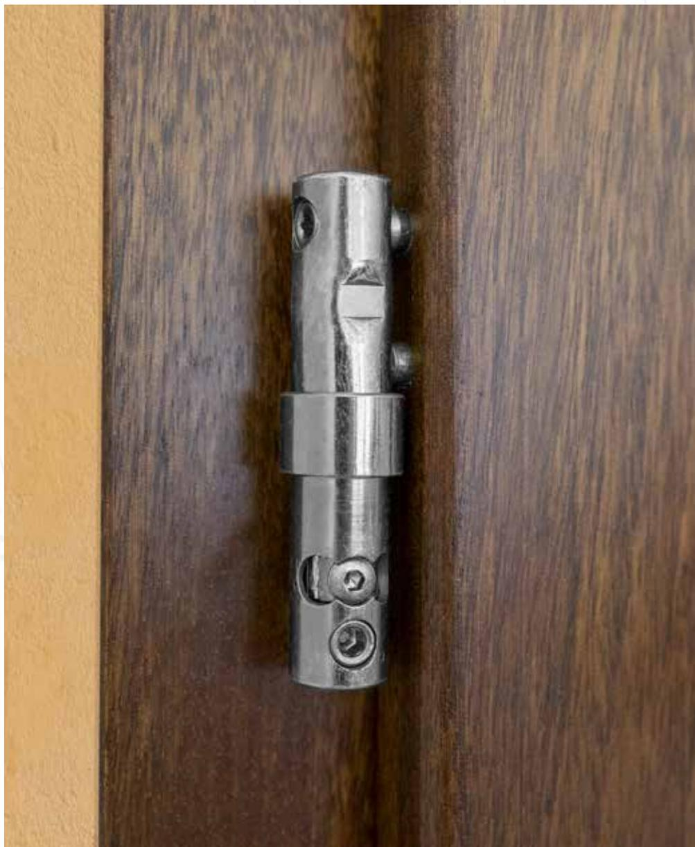
Sviluppata per abbinarsi perfettamente alla tecnologia della cerniera Exacta, rende possibile **la chiusura automatica della porta**. Velocità e forza della chiusura possono essere regolate con estrema facilità. L'autochudente Otlav è una soluzione particolarmente vantaggiosa per applicazioni su larga scala. Disponibile nel diametro da 16 millimetri.
