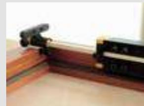
**4** - Die erste, sehr einfache Aktion für die Bohrung der Zarge ist die genaue Positionierung des umkehrbaren Verschlusses auf das Merkzeichen der Zarge.
