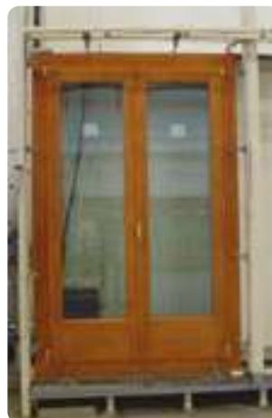
Wasser- und Wind Beständigkeitstest (bei externen Labors)
