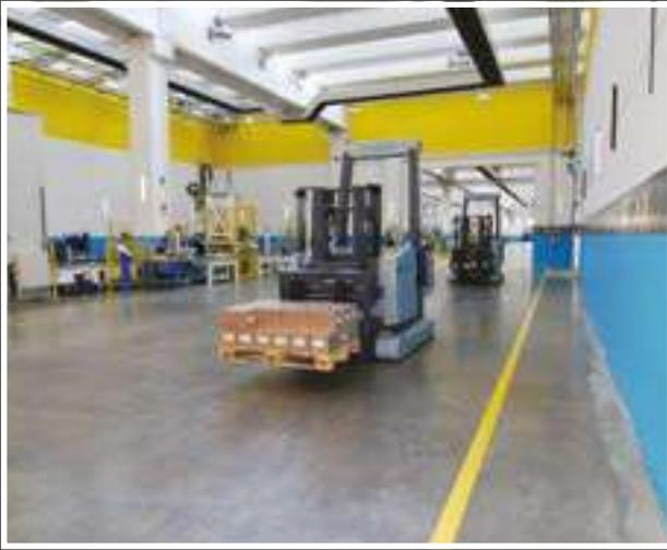
Für den der Transport der Materialien setzt das „System OAMH“) spezielle Förderautomaten ein, die so genannten **LGV (Laser Guided Vehicle)**, die eigens für Otlav entwickelt und gebaut wurden.
