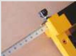
**2** - Die Millimeterstange ermöglicht die perfekte Positionierung der Bohrlehren sowohl auf den Zargen als auch auf den Flügeln.
