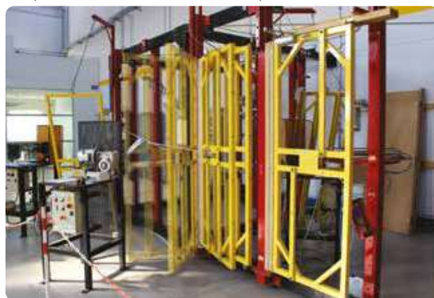
Prova di resistenza all'usura I.U.S. Otlav
