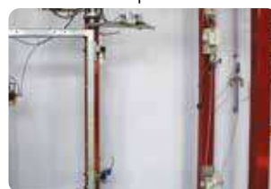
Prova di resistenza all'usura per cardini (particolare)
