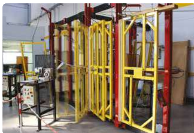
Test de résistance à l'usure I.U.S. OTLAV
