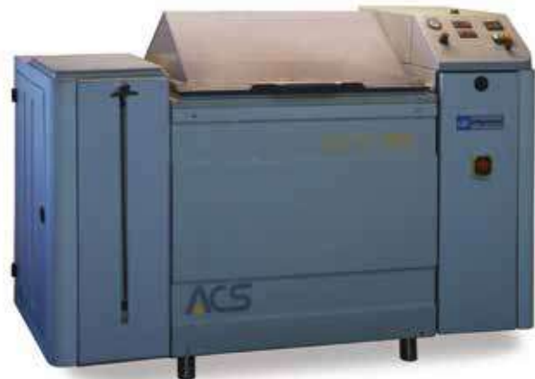
Chambre de brouillard salin: Angelantoni ACS mod. DCTC600
