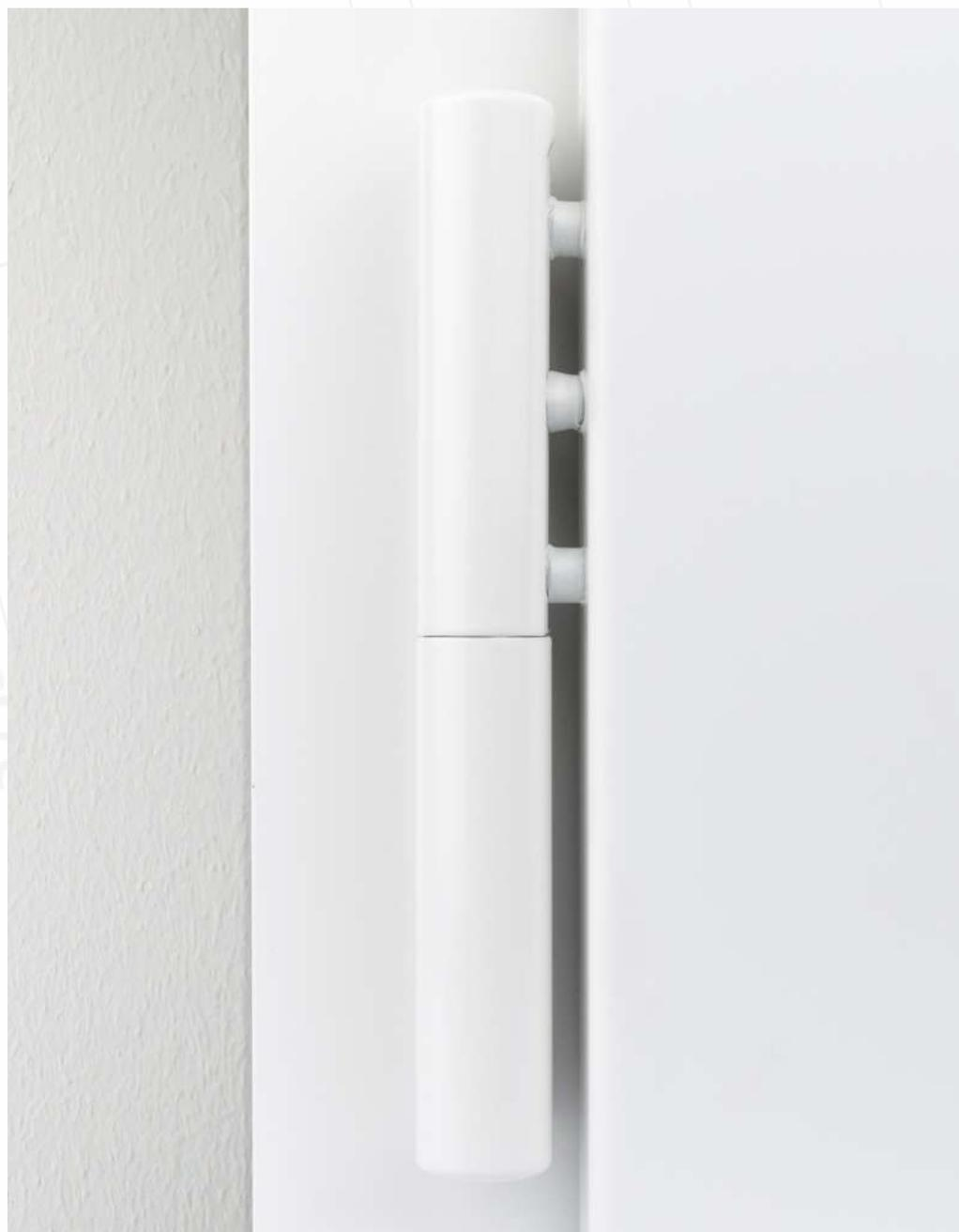
**URSUS-PVC** è composta di una femmina a 3 gambi e di un maschio con piastrina dotata di 4 fori di fissaggio, pertanto garantisce stabilità, portata ed un perfetto allineamento dell'anta; è adatta a porte e portoni particolarmente pesanti e con ante particolarmente grandi.
