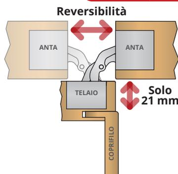
La cerniera IN300 permette di installare la cerniera al centro dello spessore dell'anta, garantendo così la **reversibilità** della porta, ed allo stesso tempo di **non lavorare il coprifiло** grazie ai soli 21 millimetri di profondità dello scafo lato stipite. Brevetto EP-B2719851.
