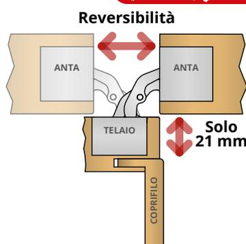
La cerniera IN303 permette di installare la cerniera al centro dello spessore dell'anta, garantendo così la **reversibilità** della porta, ed allo stesso tempo di **non lavorare il coprifiло** grazie ai soli 21 millimetri di profondità dello scafo lato stipite.
