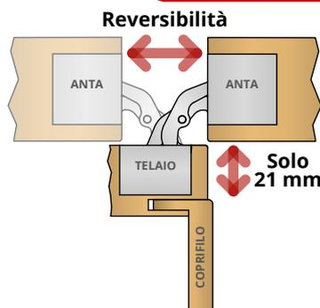
La cerniera IN305 permette di installare la cerniera al centro dello spessore dell'anta, garantendo così la **reversibilità** della porta, ed allo stesso tempo di **non lavorare il coprifiло** grazie ai soli 21 millimetri di profondità dello scafo lato stipite. Brevetto EP-B2719851.
