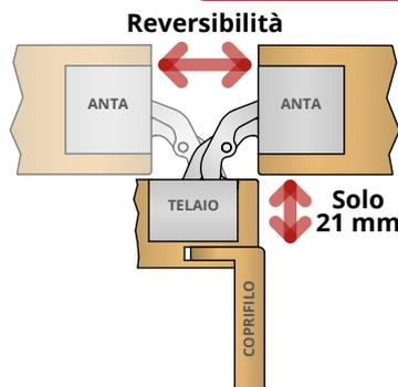
La cerniera IN300 permette di installare la cerniera al centro dello spessore dell'anta, garantendo così la **reversibilità** della porta, ed allo stesso tempo di **non lavorare il coprifiло** grazie ai soli 21 millimetri di profondità dello scafo lato stipite. Brevetto EP-B2719851.
