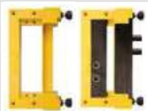
**1** - Una construcción modular permite utilizar los mismos utillajes, sustituyendo únicamente los bloques para montar diferentes tipos de pernos OTLAV.
