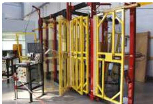
Prueba de resistencia al desgaste IUS OTLAV
