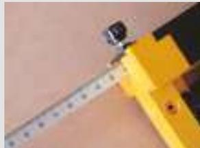
**2** - Dotado de una barra milimetrada para el perfecto posicionamiento de los utillajes sobre los marcos y hojas.
