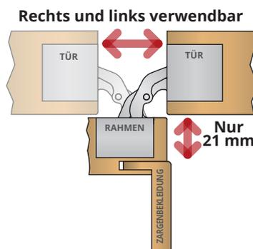
Nur das verdecktliegende Band "Invisacta" von der Firma OTLAV erlaubt die Montage des Bandes selbst in der Türmittenstärke und **garantiert damit die linke und rechte Verwendbarkeit der Tür.**
