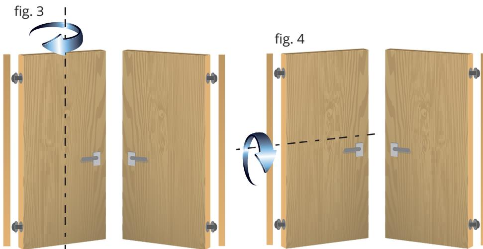
Das Invisacta Band ist rechts und links verwendbar, dies ermöglicht auch die vertikale rechte- und linke Verwendbarkeit der Tür (Bild 4).
