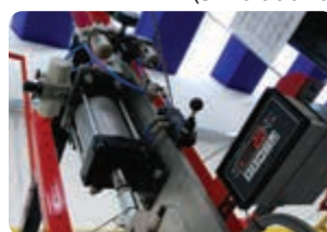
Prueba de resistencia a la extracción
