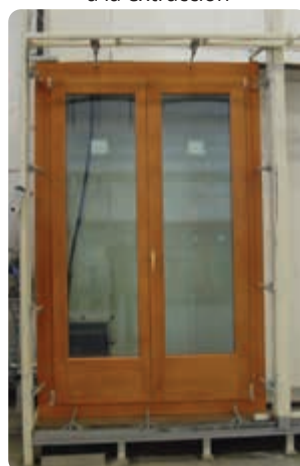
Prueba de resistencia al agua y al viento (en laboratorios externos)
