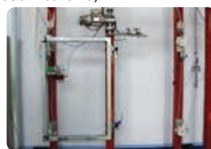
Prueba de resistencia al desgaste para gozne
