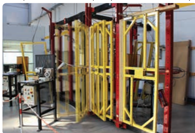
Prueba de resistencia al desgaste IUS OTLAV
