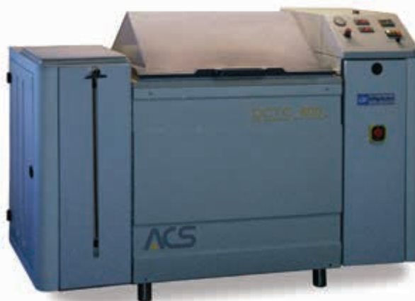
Cámara de niebla salina: Angelantoni ACS mod. DCTC600.
