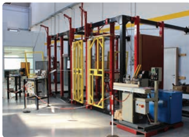
Visado de los laboratorios de pruebas OTLAV IUS (Simulador de Uso Intensivo)
