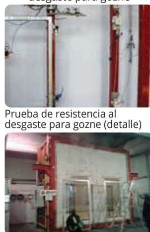
Prueba de resistencia al fuego (en laboratorios externos)
