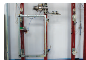
Test d'usure pour gonds
