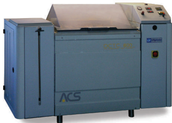
Camera di nebbia salina: Angelantoni ACS mod. DCTC600.
