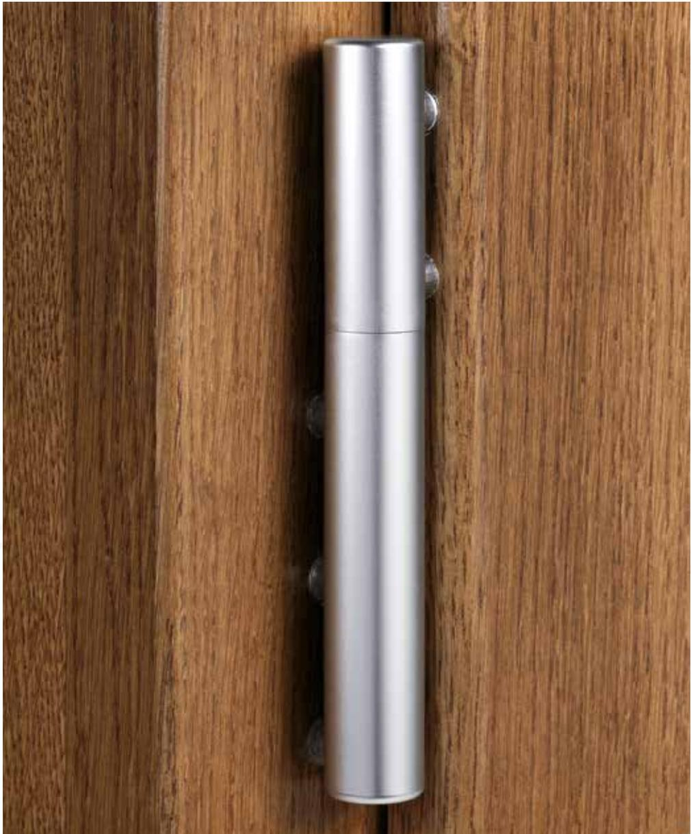
Gewährleistet mit 5 Tragstiften erhöhte Stabilität und Tragleistung. **Speziell für schwere, große Türen.** Perfekte Fluchtung der Beschläge. Vertikale, seitliche Justierung und Andruckregulierung. Das 3-teilige-Rahmenteil ist mit verschiedenen Exacta-Versionen kombinierbar. Lieferbar mit den Durchmessern: 16 und 18 Millimeter.
