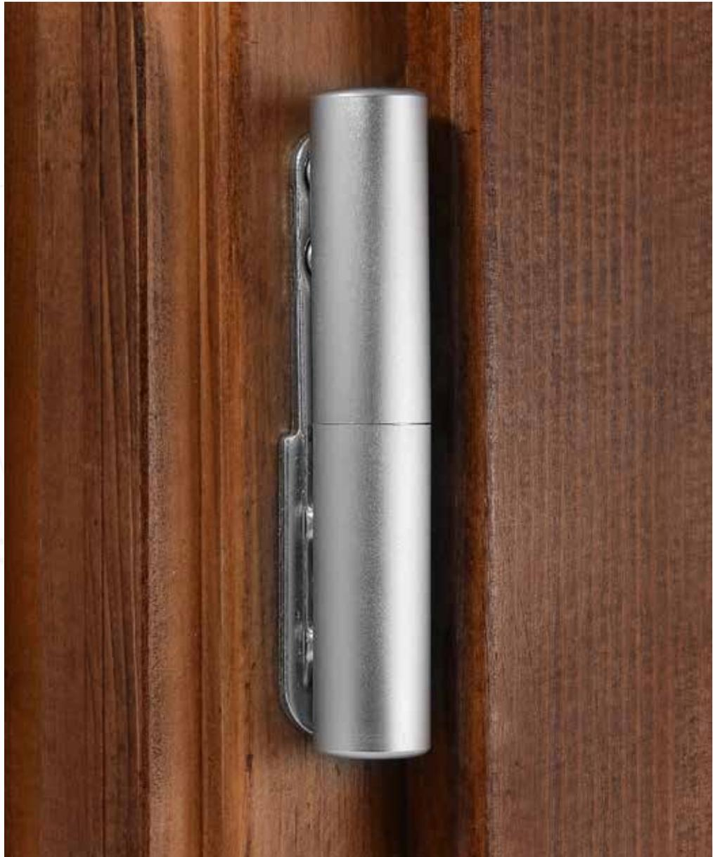
Bixacta entstand aus dem Bedürfnis heraus, über ein verstellbares Band für Türen aus PVC, Holz und Aluminium zu verfügen, das die ästhetische Wirkung an der Tür berücksichtigt. 3D-Verstellbar, das Fluegelteil wird in die Euronut 12 mit Achse 13 oder 9 fixiert, das Rahmenteil kann mit dem Rahmenteil Ursus oder Exacta Ø16 mm ausgetauscht werden. Lieferbar mit Durchmesser: 16 Millimeter.
