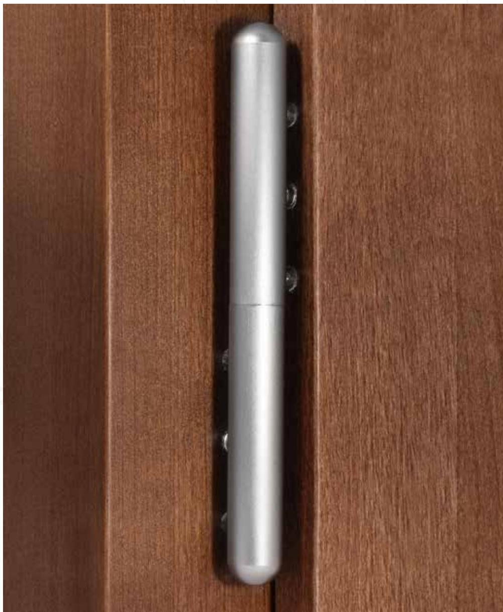
Mit 6 Bolzen bietet dieses Band eine optimale Stabilität und Tragkraft für besonders schwere und große Türen und Toren mit sehr großen Öffnungen an. Das Ergebnis ist eine perfekte Ausrichtung des Bandes. Ermöglicht die Höhen- Tiefen - und Seitliche Verstellung. Erhältlich in Durchmessern: 14 und 18 mm.
