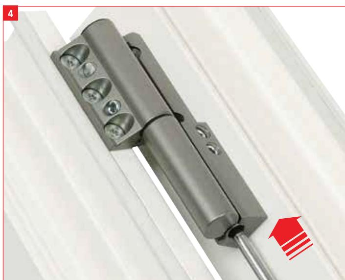
**4.** Le réglage vertical du vantail, de -1/+3mm, se fait en agissant sur l'écrou placé sous la charnière.
