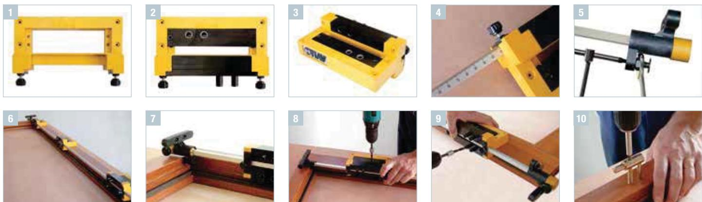
**1/2.** Une construction modulaire permet d'utiliser les mêmes gabarits, en remplaçant uniquement les blocs, pour monter différents types de fiches Otlav®.
